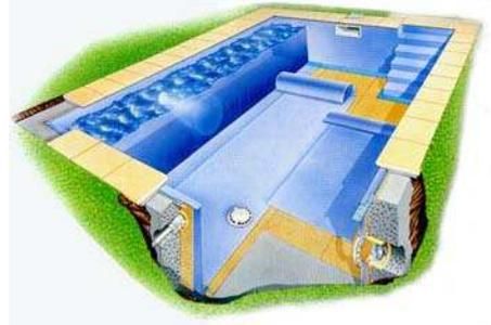
Als Beckenkörper kommt alles in Frage was dem Wasser, bei Bedarf auch dem Erddruck, standhält.
